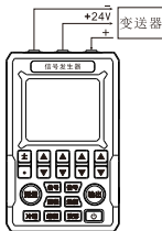
图 6 测量三线制变送器
