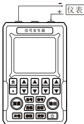
图 4 测量电压，有源电流信号
