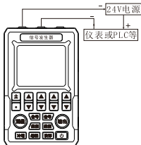
图 3 二线制变送器模拟器
